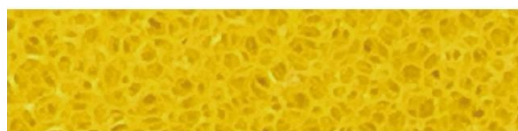
膜を取り除いた「無膜加工ウレタンフォーム」(拡大)
