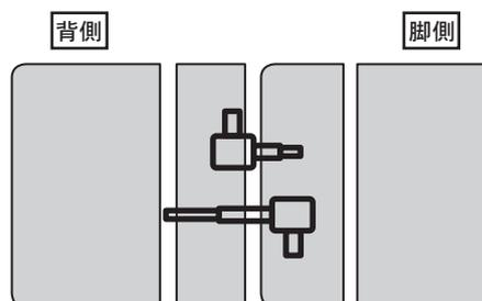
固定ボルトが確実にセットされているかを必ず確認してから使用してください。
