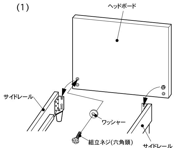
(2) 下部のネジ穴にワッシャーと組立ネジ(六角頭)を取り付けてください。
