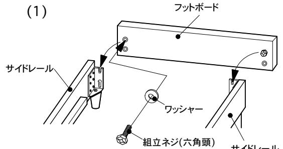
(2) 下部のネジ穴にワッシャーと組立ネジ(六角頭)を取り付けてください。
